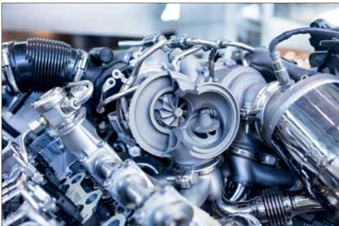
Las Aleaciones de Alto Rendimiento de VDM Metals son utilizadas en Turbocargadores por su resistencia al calor.
