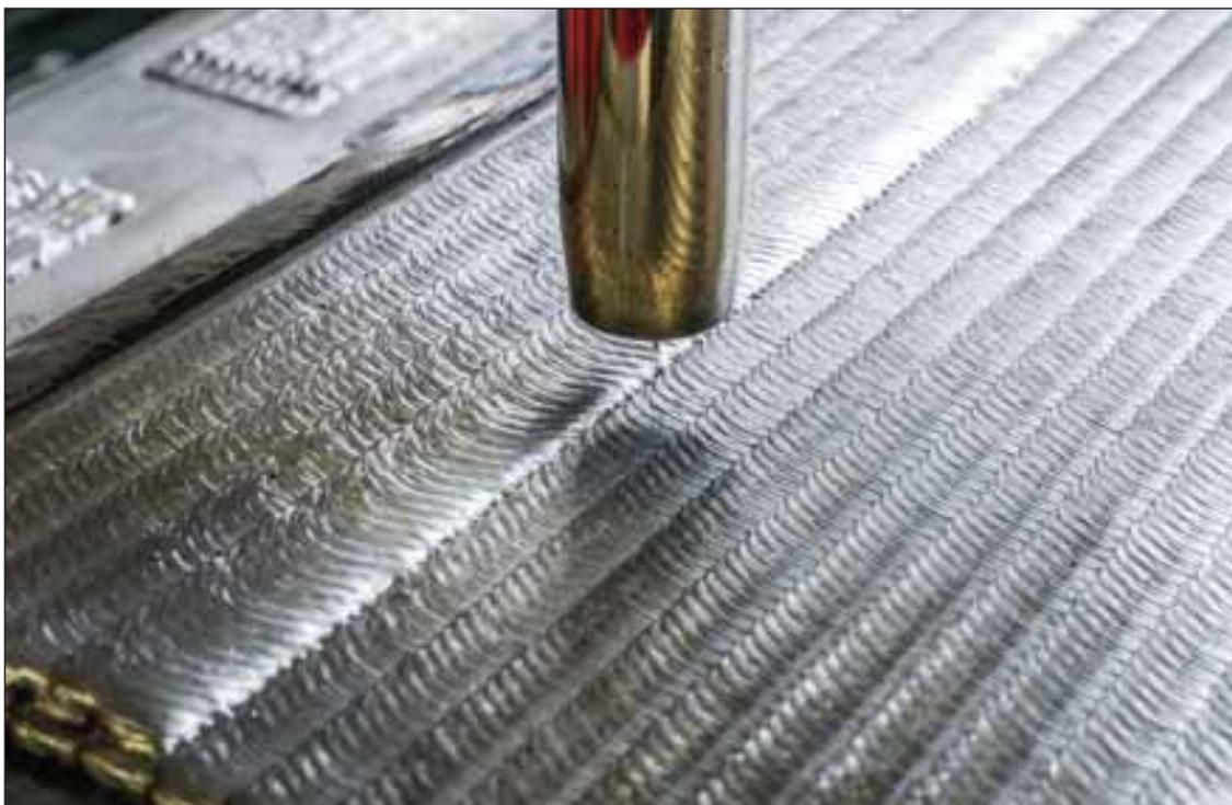
*Recubrimiento realizado en el centro de excelencia de soldadura de VDM.*
