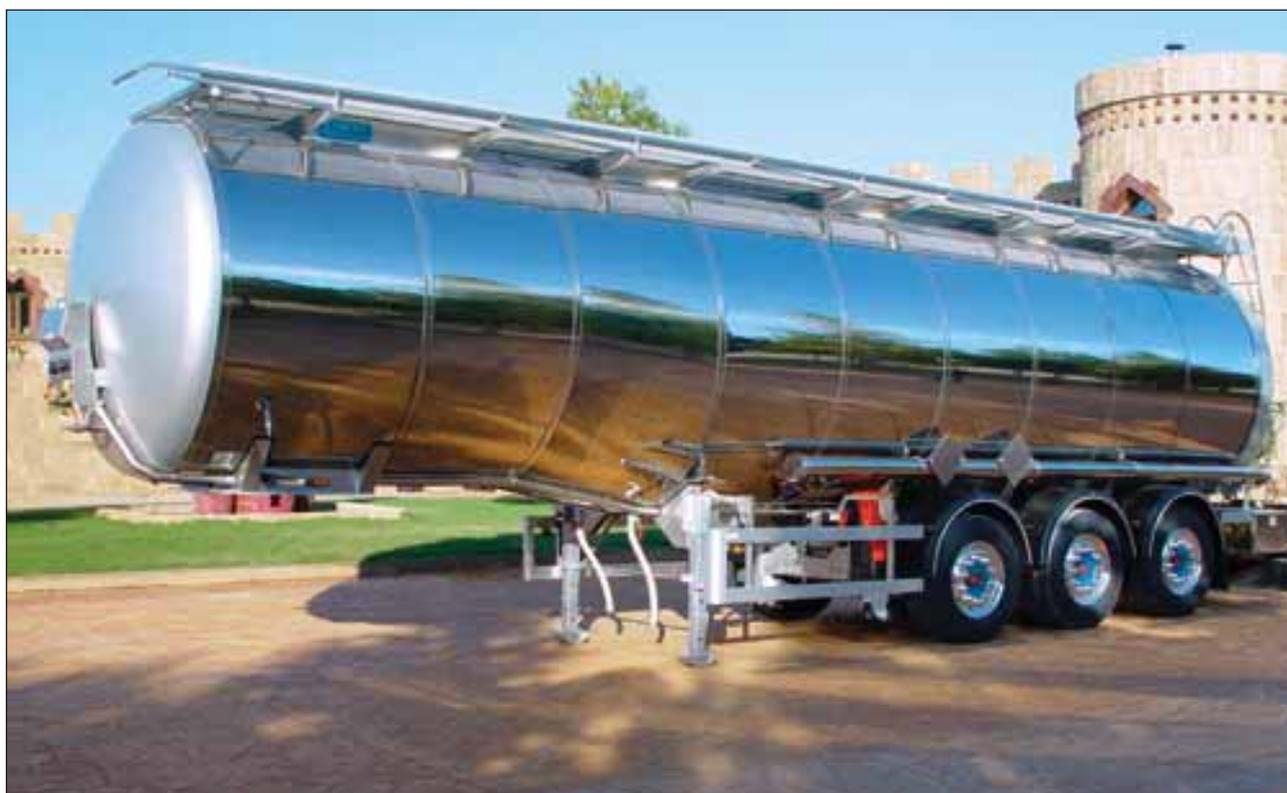
Remolque de camión fabricado con acero inoxidable.
