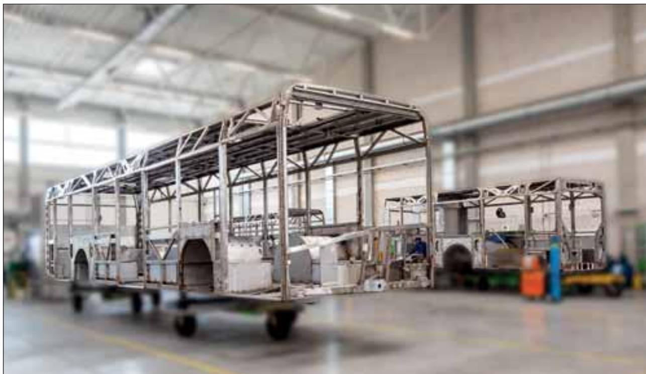
Carrocería para autobús impulsado por hidrógeno realizada con acero inoxidable producido por Acerinox.
